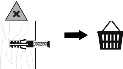
Pre vešanja nameštaja, ili pričvršćivanja ga do zida (radi osiguranja od prevrtanja), treba unapred proveriti vrstu i izdržljivost zida. Treba birati odgovarajuće ekse i vijke prema određenoj vrsti zida. U slučaju sumnje kontaktirati se sa stručnjakom. Montažu mora izvršiti kompetentno lico. **NAPOMENA!!!** Ukoliko uz proizvod priloženi su rastezni ekseri sa vijcima, to su oni namenjeni samo i isključivo za zidove izrađene iz čvrstih i jednorodnih materijala.
