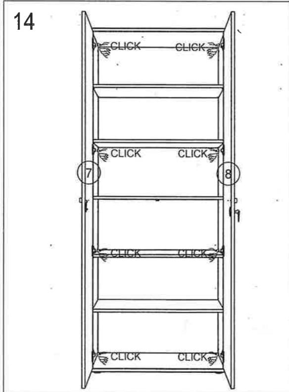
Voor de juiste regeling van de deuren moet U ervoor zorgen dat de kast goed waterpas staat. U kunt met de schroeven van de scharnieren 204 de deuren bijregelen. U kan ook de deuren verticaal bijregelen. Ontspan vijzen A en schuif de scharnierblok nr. 203 naar onder of naar boven en schroef terug vast.
