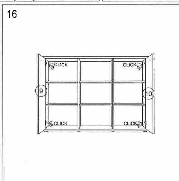
Voor de juiste regeling van de deuren moet U ervoor zorgen dat de kast goed waterpas staat, U kunt met de schroeven van de scharnieren 201 de deuren bijregelen. U kan ook de deuren vertikaal bijregelen. Ontspan vijzen A en schuif de scharnierblok nr. 203 naar onder of naar boven en schroef terug vast.
