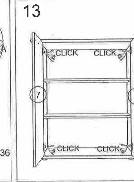
Voor de juiste regeling van de deuren moet U ervoor zorgen dat de kast goed waterpas staat. U kunt met de schroeven van de scharnieren 201 de deuren bijregelen. U kan ook de deuren verticaal bijregelen. Ontspan vijzen A en schuif de scharnierblok nr. 203 naar onder of naar boven en schroef terug vast.
