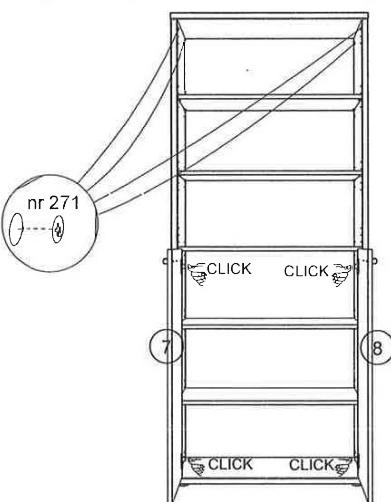
Voor de juiste regeling van de deuren moet U ervoor zorgen dat de kast goed waterpas staat, U kunt met de schroeven van de scharnieren 201 de deuren bijregelen. U kan ook de deuren verticaal bijregelen. Ontspan vijzen A en schuif de scharnierblok nr. 203 naar onder of naar boven en Schroef terug vast.
