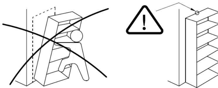
**DANSK** - VIGTIGT! Skruen som følger med væltesikringen er kun til at fæstne væltesikringen i møblet. Enkelte produkter forankres direkte i væg (uden beslag) og her vil der ikke medfølge nogen skrue. Du skal derfor supplere med en skrue eller et beslag som passer til det materiale din væg er lavet af. Hvis du er usikker så kontakt din lokale fagmand.
