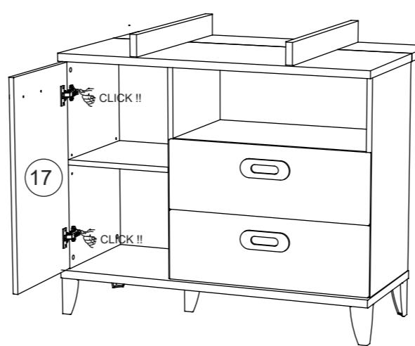
Voor de juiste regeling van de deuren moet U ervoor zorgen dat de kast goed waterpas staat, U kunt met de schroeven van de scharnieren 204 de deuren bijregelen. U kan ook de deuren verticaal bijregelen. Ontspan vijzen A en schuif de scharnierblok nr. 203 naar onder of naar boven en schroef terug vast.
