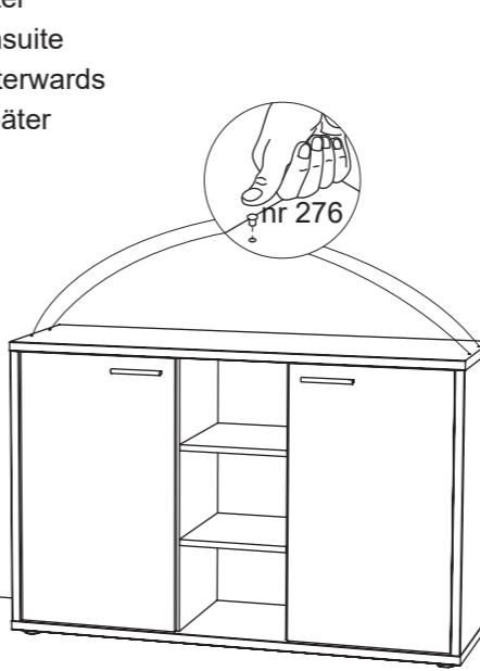
Voor de juiste regeling van de deuren moet U ervoor zorgen dat de kast goed waterpas staat, ook kunt U met de schroeven van de scharnieren 201 de deuren bijregelen. U kan ook de deuren verticaal bijregelen. Ontspan vijzen A en schuif de scharnierblok nr. 203 naar onder of naar boven en Schroef terug vast.
